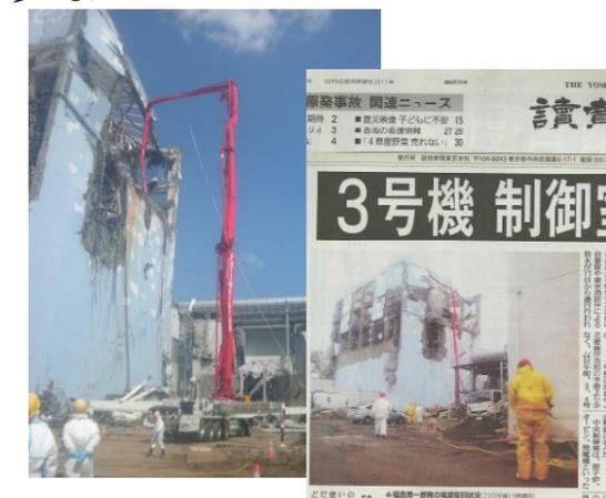
プツマイスターのロングブームポンプ車は、福島第1原発事故に際して使用済み燃料プールの外部冷却緊急対応で貢献しました。
